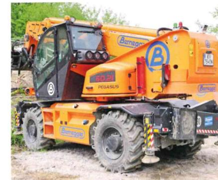
Das Abladen und der Transport der Bohrpfähle sowie der Auf- und Abbau des Bohrgerätes erfolgte mit einem Dieci Pegasus 6021.
